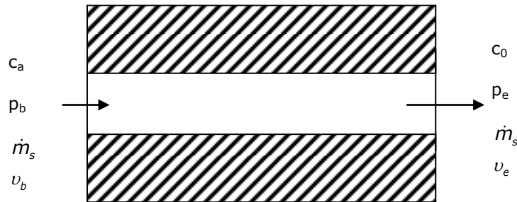
Afbeelding 10. Schematische weergave van een rechte straalbuis.
